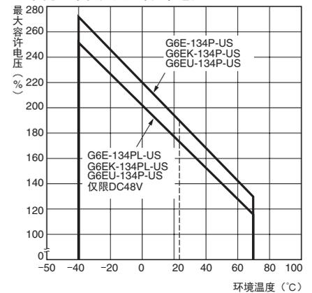
注:最大容许电压为继电器线圈能够施加的电压的最大值。
