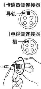
(注1)：请务必将固定环旋转到停止。否则松动将不保证防水性。
